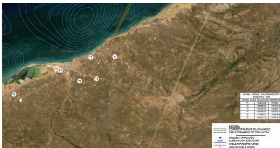
Imagen 9. Detalle de la conexión a la línea de evacuación energética del Parque Eólico Musichi.
